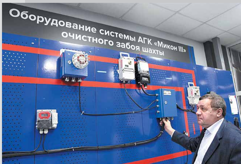
Система «МИКОН III» предназначена для автоматического непрерывного измерения параметров состояния промышленных и горно-технологических объектов
